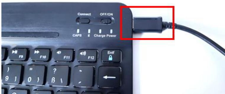
Die LED-Anzeige für den Ladeprozess (Charge) leuchtet bei Laden rot auf und erlischt wenn der Akku vollständig aufgeladen worden ist:
